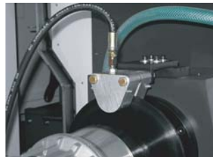
C-ekseni için hidrolik fren
