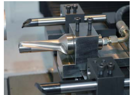
Gang tip sistemlerde opsiyonel olarak takım içinden su verme özelliği alınabilir
