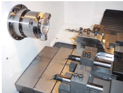
NCL-30 ve NCL-42'de "B" versiyonlarında sadece "gang" sıra takım sistemi vardır
