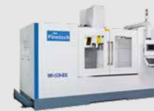
▲ 1570-H3L • Travel : X1500 Y700 Z650 mm • Table : L1650×W700 mm
