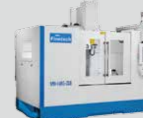
▲ 1485-2LB ▲ 1685-2LB • Travel : X1400 Y850 Z850 mm • Table : L1500×W800 mm
