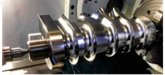
U1530 4. Eksen Uygulaması
