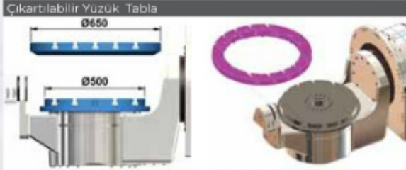
Küçük parçaları işlerken yanışmadan dolayı yaşanan problemler için fişürü uzatmak zorunda bırakmayan çıkartılabilir tabla yapısı
